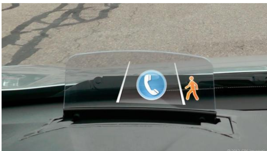
تصویر ۳. سامانه تعاملی ایمنی عابر پیاده نصب شده در خودرو
